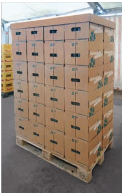
Das Gewicht ruht beim Stapeln auf den Flaschenverschlüssen, die Wellpappe wird nicht belastet. Bis zu acht Kisten übereinander sind möglich.
